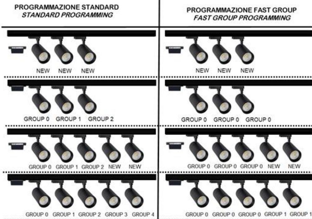
La luminosità delle lampade seguirà lo slider corrispondente al gruppo assegnato: lo Slider 0 controllerà la luminosità delle lampade programmate Gruppo 0, lo Slider 1 controllerà quella delle lampade programmate Gruppo 1 e così via.
